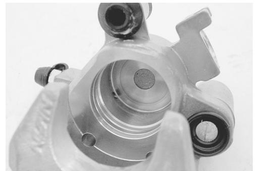
**BRAKE CALIPER PISTON**
